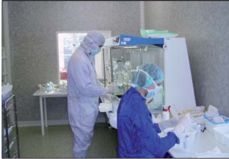
Obrázek 4. Práce v prostorech třídy čistoty C s laminárními boxy třídy čistoty A
