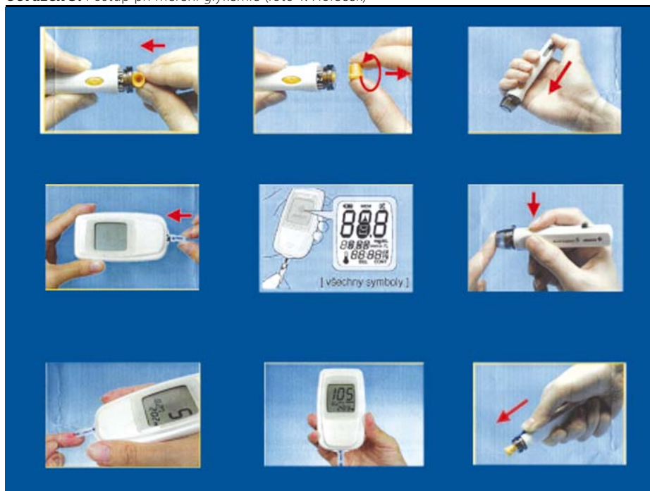
Obrázek 3. Postup při měření glykemie (foto T. Holeček)
